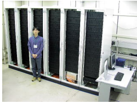
図1 (独) 産業技術総合研究所・爆発安全研究センターのセルフメイド PC クラスタ (ミリネット接続 Xeon 2.8 GHz x 128)
