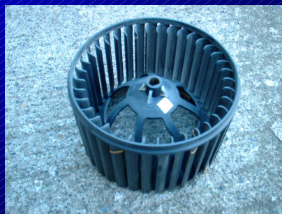
コーン部開口を有する 羽根車
