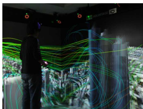
図.11 VR空間において,ビル後方の渦の3次元な挙動を把握している様子
