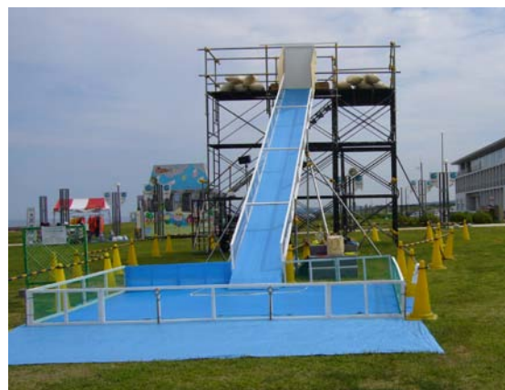
図4 「ピンポン玉なだれ実験」の装置
