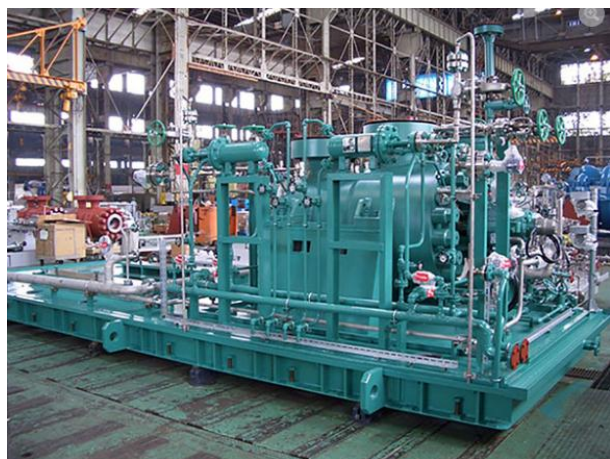
図5 高圧ポンプ、および補機類
