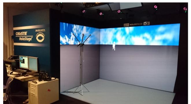
図-5 没入型 VR 装置 HoloStage
