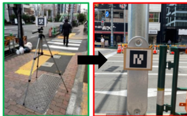
(a) 三脚を用いたマーカー (b) 固定構造物を用いたマーカー
